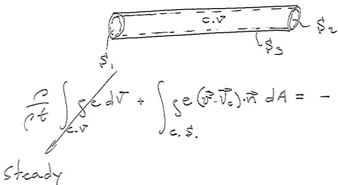
$$\frac{\rho}{C_p} \int_{c.v.} \vec{S} e dV + \int_{c.s.} g e (\vec{v}^2 - \vec{v}_0^2) \cdot \vec{n} dA = - \int_{c.s.} P \vec{n} \cdot \vec{v} dA + \int_{c.s.} \vec{v} \cdot \vec{E}' \cdot \vec{n} dA + \int_{c.v.} \vec{S} \vec{v} \cdot \vec{v} dV + \int_{c.v.} \vec{Q} \cdot \vec{v} dV$$
