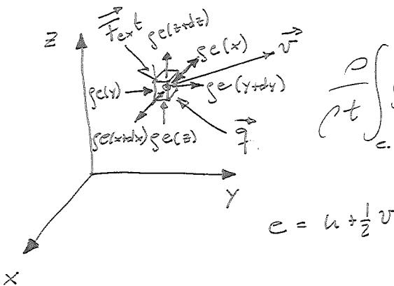
$$\frac{\rho \dot{e}}{\rho t} \int_{c.v.} \rho dV + \int_{c.s.} g_e(v - v_c) \cdot \vec{n} dA = - \int_{c.s.} \rho \vec{n} \cdot \vec{v} dA + \int_{c.s.} \vec{v} \cdot \vec{\Xi}' \vec{n} dA \\ + \int_{c.v.} g \vec{g} \cdot \vec{v} dV + \int_{c.v.} \dot{Q}_{rad} dV - \int_{c.s.} \vec{q} \cdot \vec{n} dA$$
