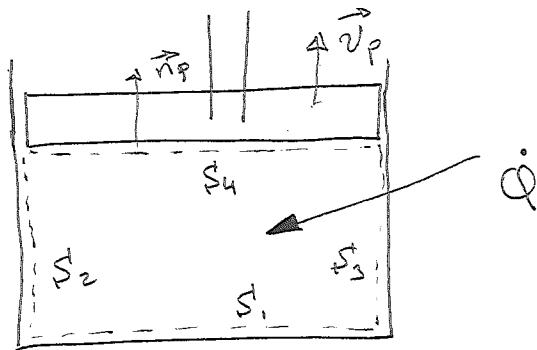
$$\oint_C \int_{C.V.} \rho e dV + \int_{C.S.} \rho e (\vec{v} - \vec{v}_o) \cdot \vec{n} dA = \left( -P \vec{v} \cdot \vec{n} dA + \int_{C.S.} \vec{v} \cdot \vec{\tau} \cdot \vec{n} dA + \int_{C.V.} \vec{s} \vec{v} \cdot \vec{v} \right)$$
