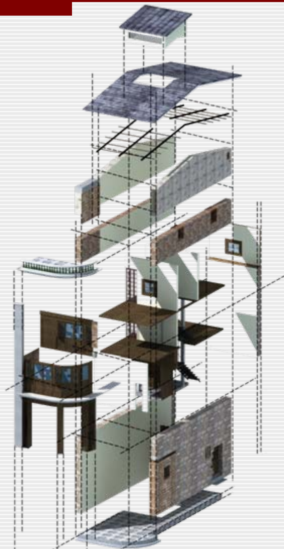
改造后建筑分解图
